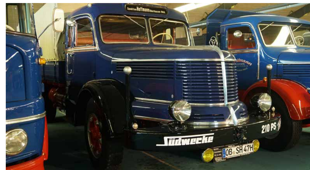
PRACHTSTÜCK: Der Krupp Titan von 1952 hat nicht nur zwei Motoren, sondern auch serienmäßig Knorr-Bremse Originalteile verbaut.
